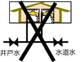
◎水道水と井戸水等を併用して利用している場合は、右図のように必ず、配管を別にしてください。
