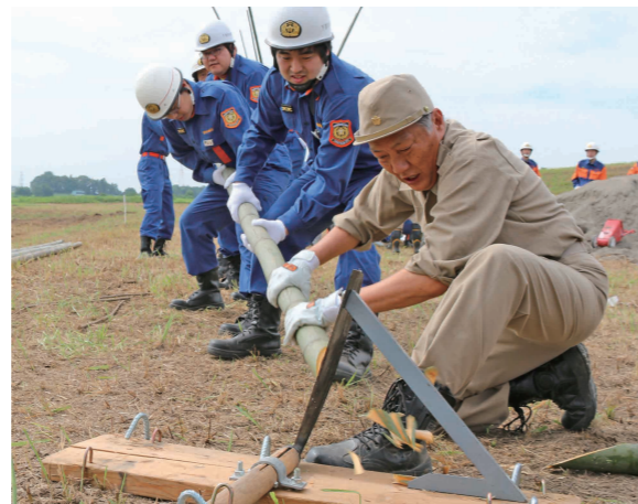
長い竹を削り、先端を鋭くして杭状にする「竹とげ」の作業息を合わせて竹を引く下妻市消防団員
