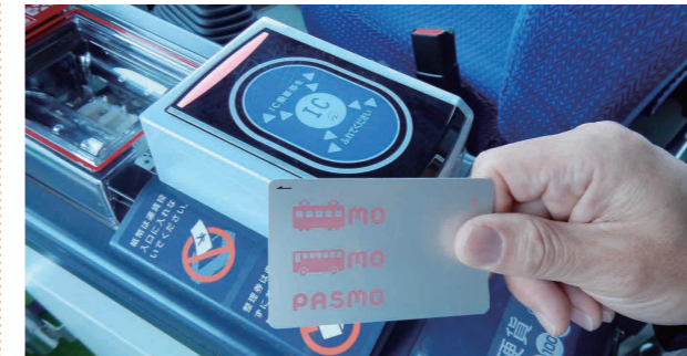
車内に設置されたICカードリーダー
