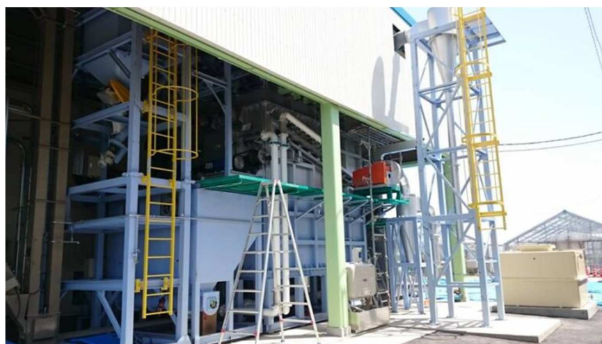
図 6-5 もみ殻処理炉 (JA いみず野) (出典：株式会社グリーンプロダクション Web ページ)
